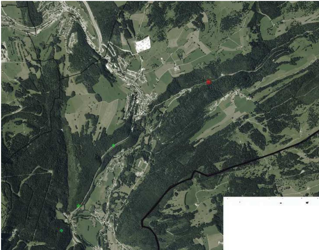
**FIGURE 26 : EBOUEMENTS RECENSES ET LOCALISES SUR LA COMMUNE. EN VERT LES ÉBOUEMENTS ET EN ROUGE LE GLISSEMENT. SOURCE : WWW.GEORISQUE.GOUV.FR; MISE EN FORME DORGAT**
